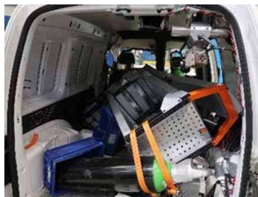
Figur 5. Fast last efter krock
