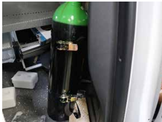
Figur 6. Gasflaska mot mellanvägg
