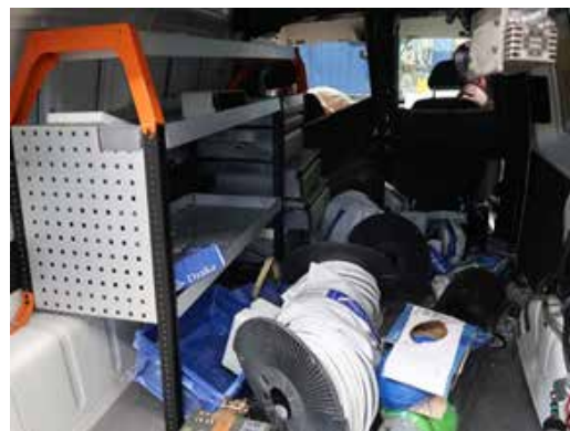
Figur 13. Lös last efter krock
