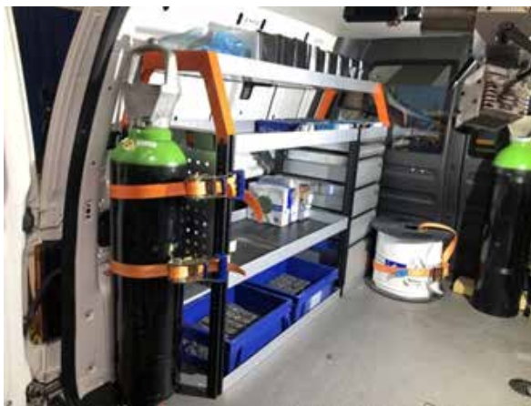
Figur 3. Bil 1 med förankrad last
